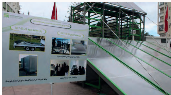
Figure 16. Système de séchage des produits agricoles à l'aide de l'énergie solaire
